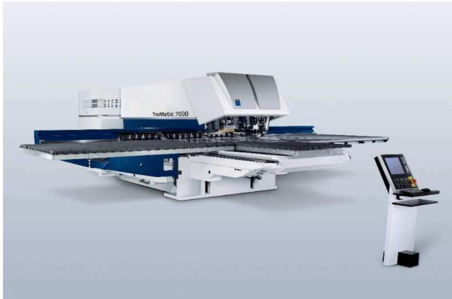
Mit der TruMatic 7000 können wir nun Laserschneid- und Stanzarbeitsgänge in nur einem Fertigungsschritt durchführen und dadurch eine **deutliche Zeitersparnis** realisieren.
