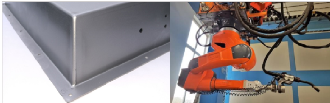
Detailaufnahme einer gestrahlten Schweißnaht, Roboterarm der Schweißroboteranlage
