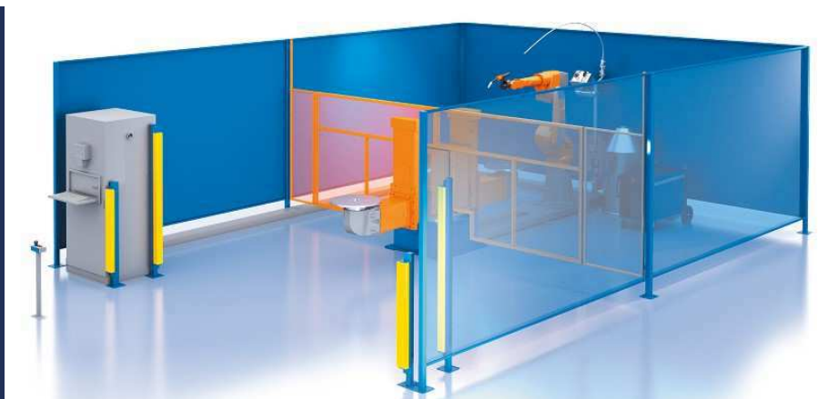
Bild 1: 6-Achs-Schweißroboter der Firma Cloos
