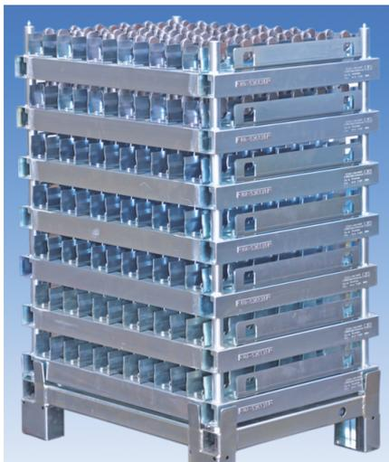
Dieser Palettenstapel besteht aus einer Grundpalette mit Ölwanne und Stapelpaletten. Durch moderne Laser- und Abkanttechnik konnten die Aufnahmeschienen aus einem Stück und damit wesentlich kostengünstiger und stabiler hergestellt werden. Der Stapelaufbau ist von dem seit Jahren bewährten Palettenbaukasten nach DIN 24602 abgeleitet.
