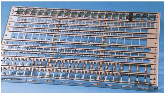
Für die Bereitstellung eines Teilesatzes für Schutzschalter in der Reinraumproduktion, wurde dieser Werkstückträger entwickelt. Die Aufgabe für unsere Entwickler war, einen Träger zu gestalten, der zehn unterschiedliche Einzelteile aufnehmen kann, die nach der Ultraschallreinigung einer Reinraummontagezelle zugeführt werden.
