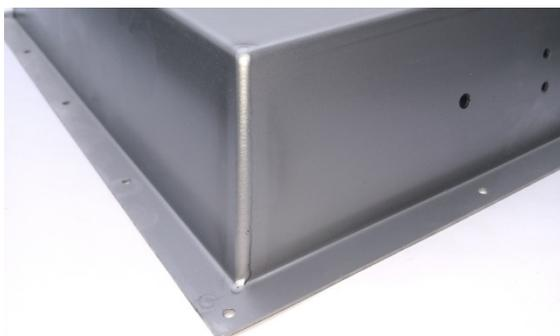
Bild 2: Detailaufnahme einer gestrahlten Schweißnaht
