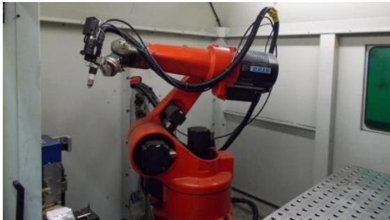
Bild 1: Roboterarm Schweißanlage
