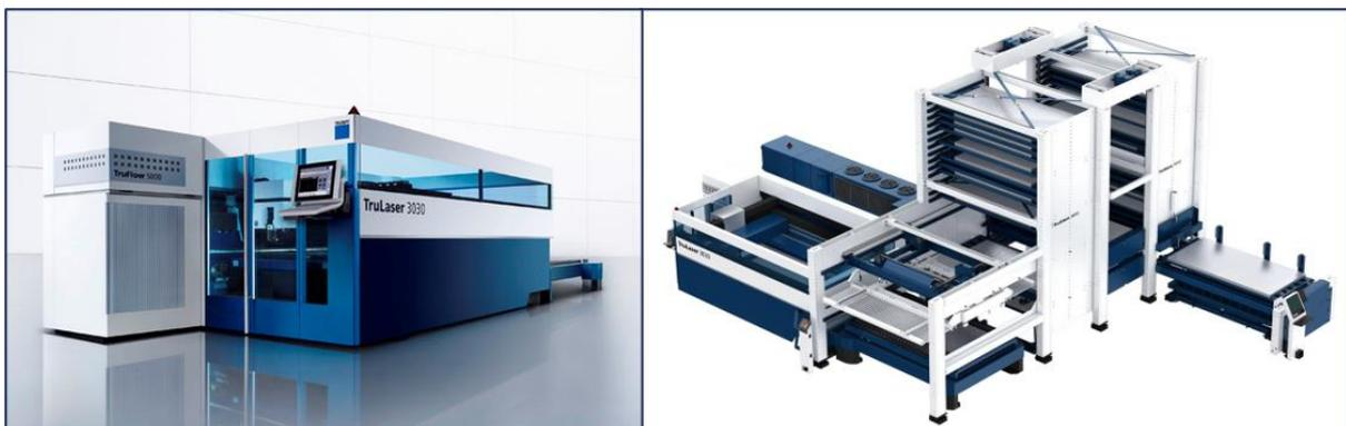
Dadurch sind wir in der Lage, neben dem Feinblech-Spektrum bis max. 5mm Dicke auch Laserteile bis zu [25mm | 20mm | 15mm] Stärke in den Werkstoffen [Stahl | Edelstahl | Aluminium] für Sie zu schneiden. Unsere vier TRUMPF-Biegemaschinen mit den Kantlängen 1m, 2m, 3m und 4m verarbeiten dabei eine Blechdicke von bis 8mm.
