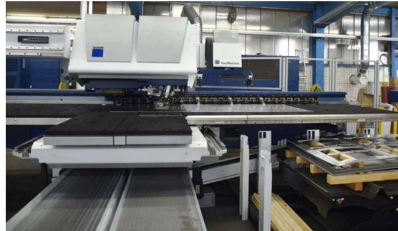
TruMatic 7000 – Kombinierte Laser-Stanz-Maschine
