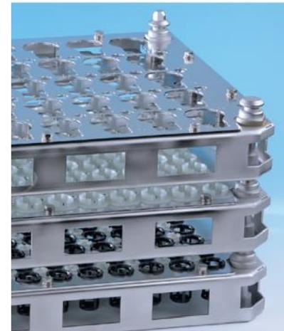
Palettensystem für die automatisierte Fertigung von Einspritzdüsen
