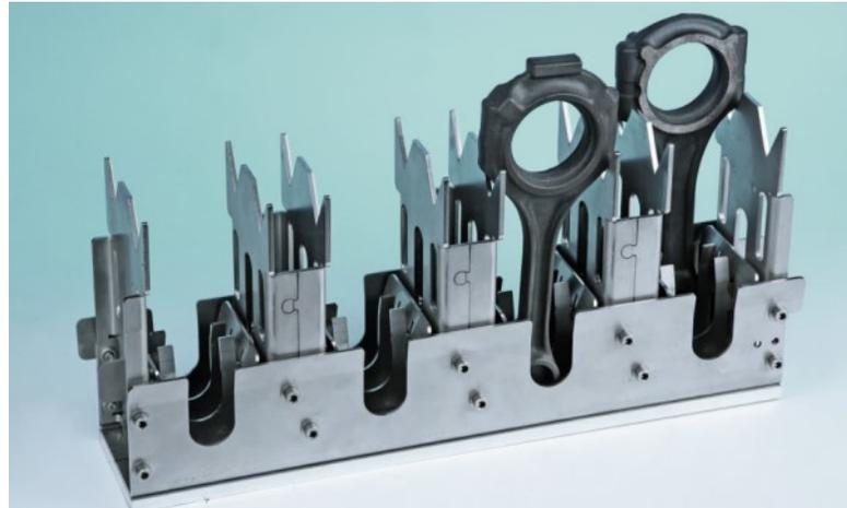
Werkstückträger zur Bereitstellung von Pleuelstangen
